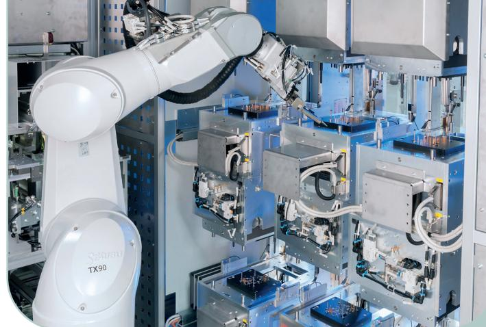
Der **baumann multitester** ist die modulare Plattform für kombinierte Prüftechnikapplikationen, insbesondere, wenn eine hohe Anzahl von Kontaktier- oder Prüfmechaniken benötigt wird.
